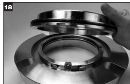
18 Déposez l'adaptateur du chapeau. Déposez le joint torique de l'adaptateur (Z) et mettez-le au rebut. Mettez l'adaptateur de côté.
