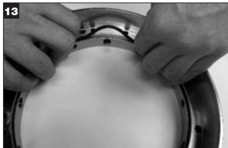
13 Déposez le joint torique de la bague de verrouillage (Y) et mettez-le au rebut.
