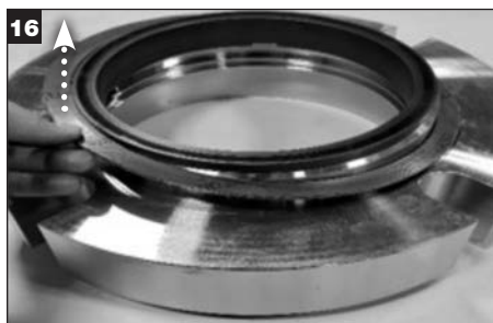
16 Déposez le joint d'étanchéité de l'adaptateur et mettez-le au rebut.
