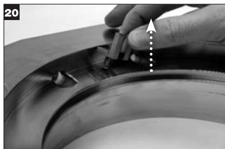
20 Déposez l'ensemble d'entraînement du chapeau et mettez-le au rebut.
