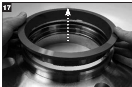
17 Déposez la bague d'étanchéité stationnaire interne du chapeau et mettez-la au rebut.
